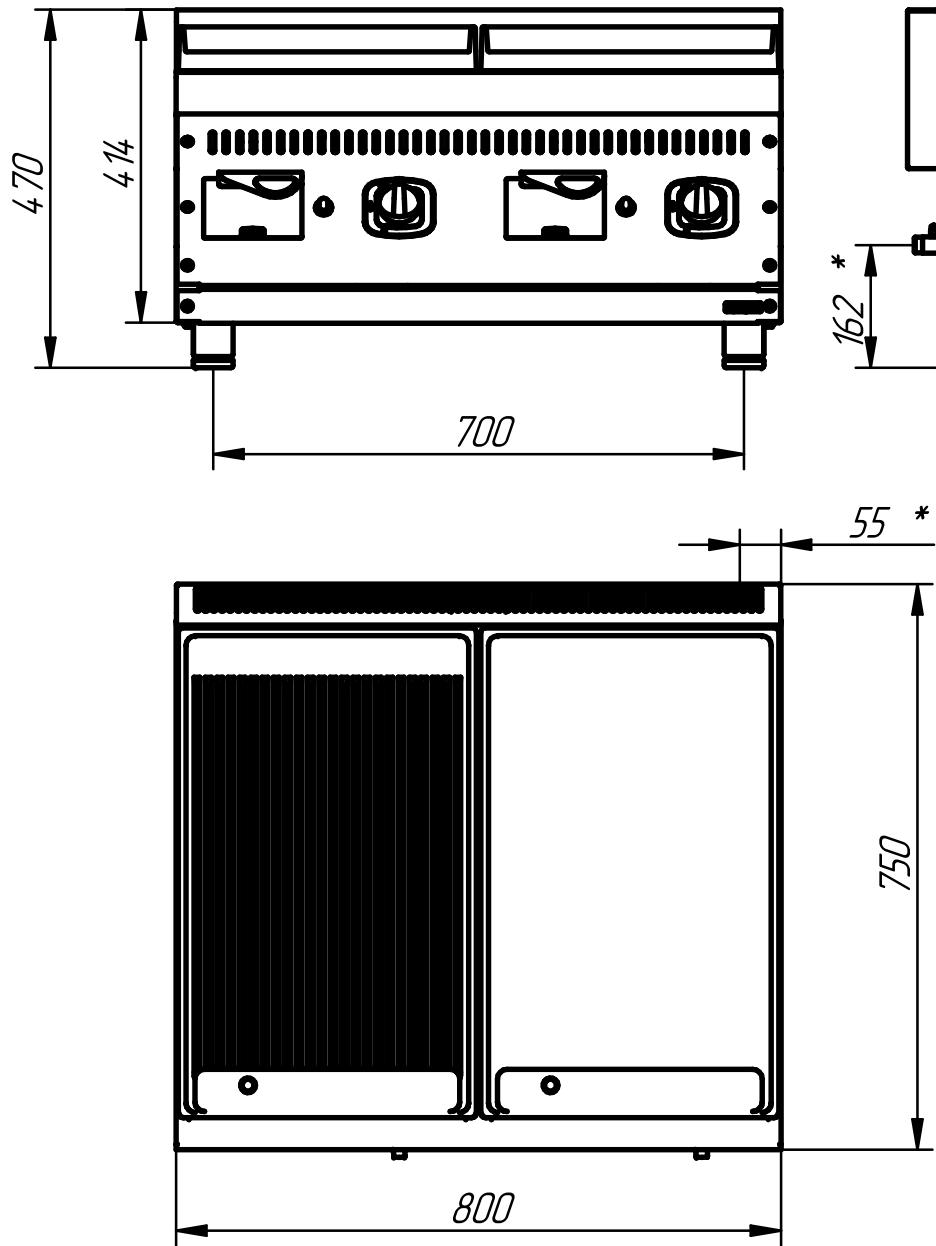
Аппарат газовый контактной обработки предназначен для приготовления пищи путем непосредственного контакта греющей чугунной поверхности с одной стороной обрабатываемого продукта, полуфабрикатов из мяса, рыбы, овощей, мелкоштучных изделий на предприятиях общественного питания, как самостоятельно, так и в составе технологических линий. Работает как от природного так и сжиженного газа. Имеет регулируемые по высоте ножки.
